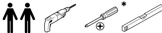
\* **VORSICHT:** Bei Verwendung eines Akkuschraubers (nicht empfohlen) möglichst niedrige Drehmomentstufe wählen!
